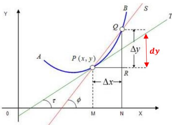
Figura 3. Significado geométrico del diferencial de una función.
